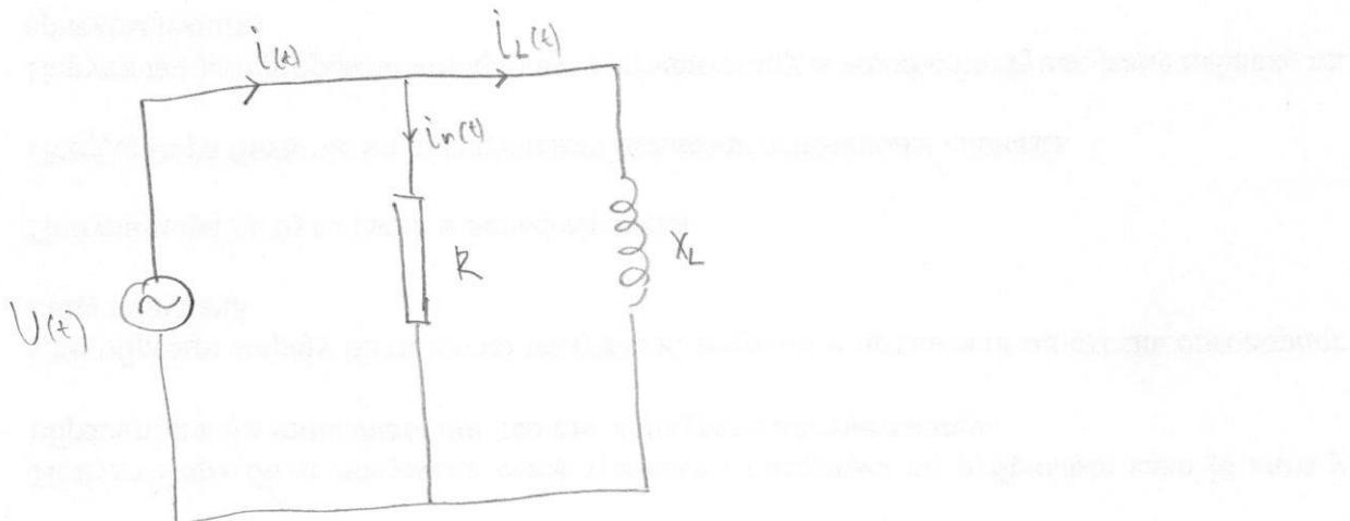
Како је напон испод на омпорику и на капацитету фазор напона у фазнији оси. Дасор струје кроз омпорик је у фази са фазором напона. Дасор струје кроз кондензатор је фазору напона за  $\frac{\pi}{2}$ . Збир фазора струје кроз омпорик и кондензатор дате фазор резултантне струје, и то узимаје струје паралелног RL кона.
