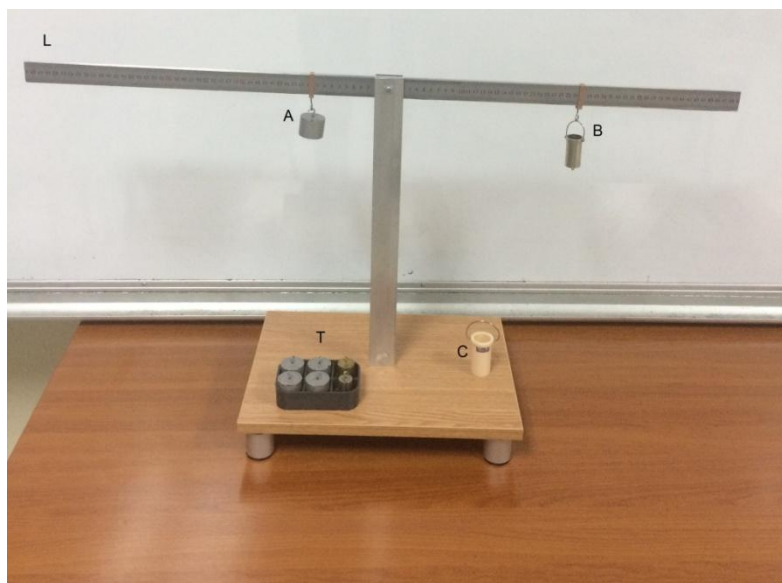
СЛИКА 3. Апаратура: (L) метарски лењир, (A) тег, (B) тест посуда, (T) тегови, (C) посуда за течност.
